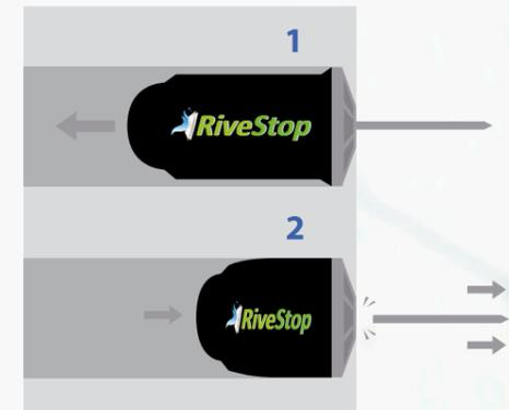
SCHRITT 1: Führen Sie RiveStop in die abzudichtende Öffnung ein
