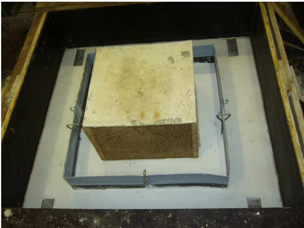
Bild A3: Versuchskörper vor der zweiten Betonage
